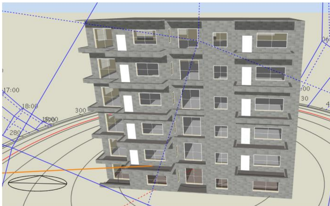
الشكل رقم (10.4): إضافة بلكنات في الواجهة الجنوبية للتظليل بحيث لا تمنع دخول اشعة الشمس في بداية الشتاء
